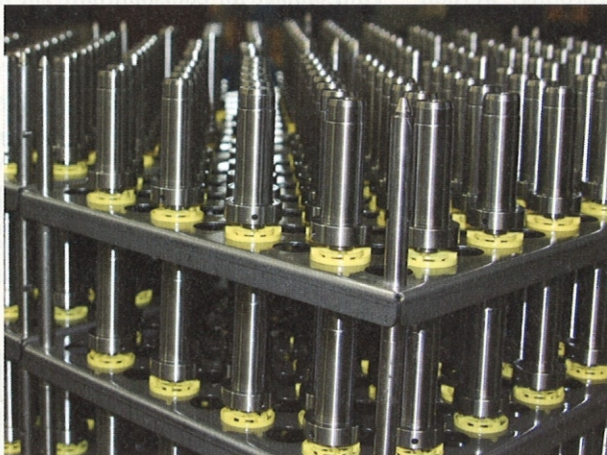
Bei Häring werden unter anderem größere Edelstahl-Komponenten als Steckware gereinigt
